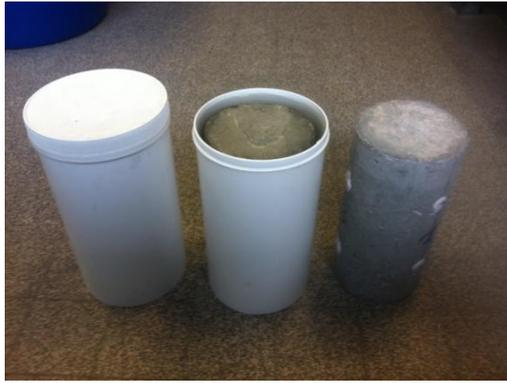
**Figure II.9 : conservation des éprouvettes dans l'eau**
