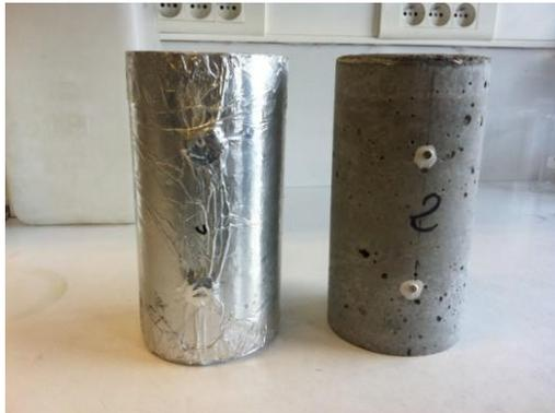
**Figure II.10 : isolement du béton par des couches d'aluminium**
