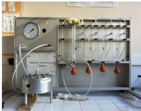
Figure II.17 : perméamètre à gaz Cembureau
