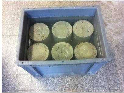
**Figure IV.1 : immersion des matériaux dans l'eau**
