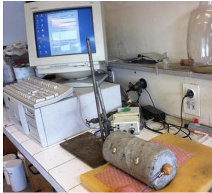
**Figure II.13 : dispositif de mesure du module dynamique**
