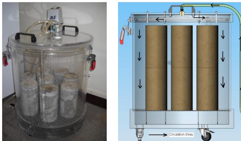
**Figure III.2 : dispositif de maintien à 100% d'HR**
