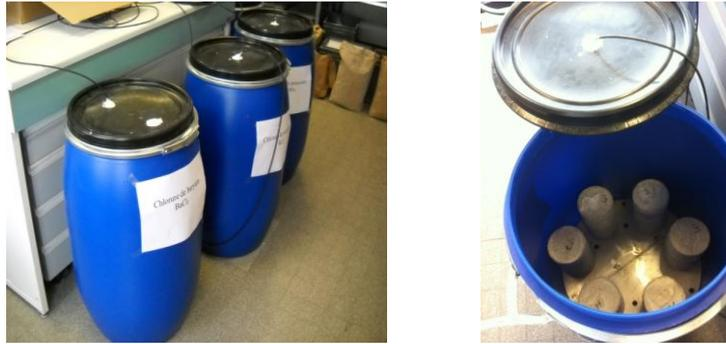
**Figure III.3 : dispositifs de conservation sous 91% $<HR<$ 98%**
